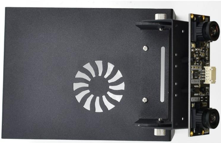
11. 将摄像头排线接入 Jetson Nano。注意金属面朝向散热板方向
