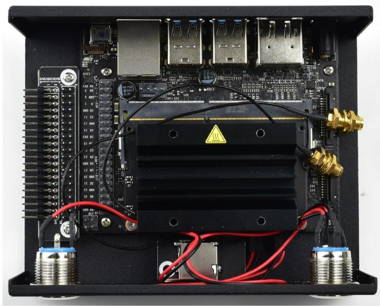
6. 将无线网卡天线固定在金属盒上。并将散热风扇转入 Jetson Nano
