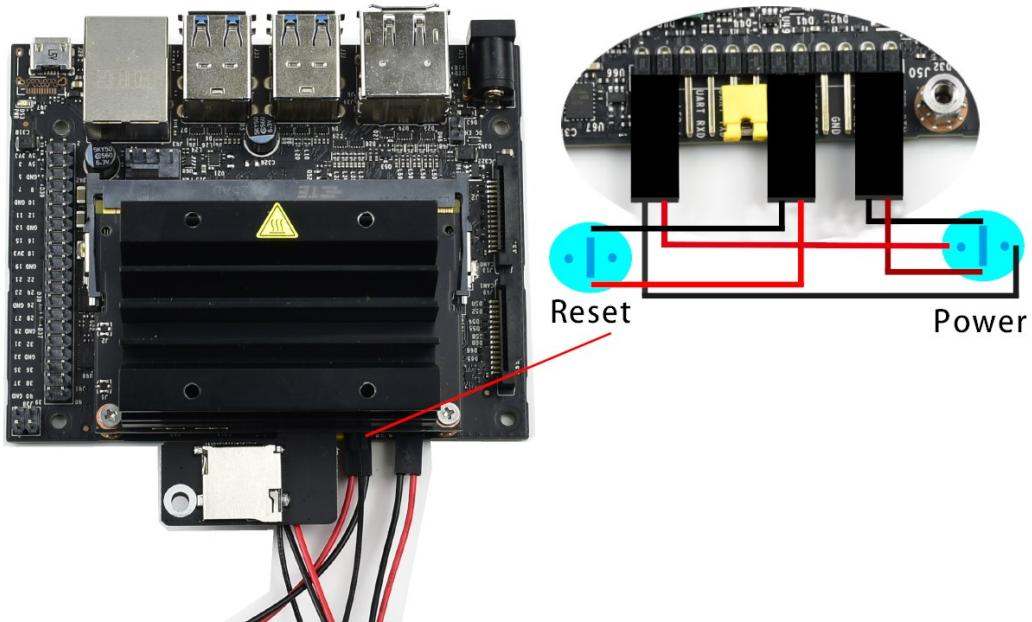
4. 将 Jetson Nano 装入金属底盒。稍微调整一下排线。用螺丝将 Jetson nano 和 TF 卡转接板固定在底盒上（注意这里如果没有将 TF 卡插紧，螺丝孔位会对不上）
