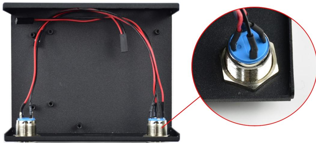
3. 将按键连接到按键接口, 同时将 TF 卡转接板插入 TF 卡卡槽。插入的时候需要按压一下, 让转接板完全插入。注意, 在操作 TF 卡转接板的时候, 要特别小心, 取出时要先按一下确保转接板已经完全弹出然后再取出, 不能直接拔下来, 否则容易损坏 TF 卡卡槽。
