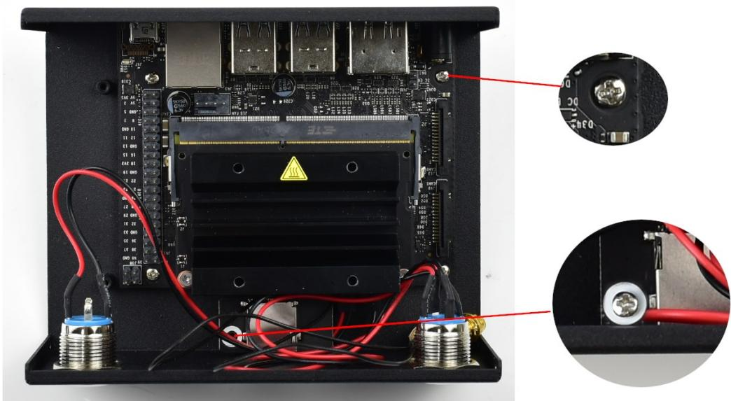
5. 将 GPIO 转接板用螺丝所在金属底盒上。
