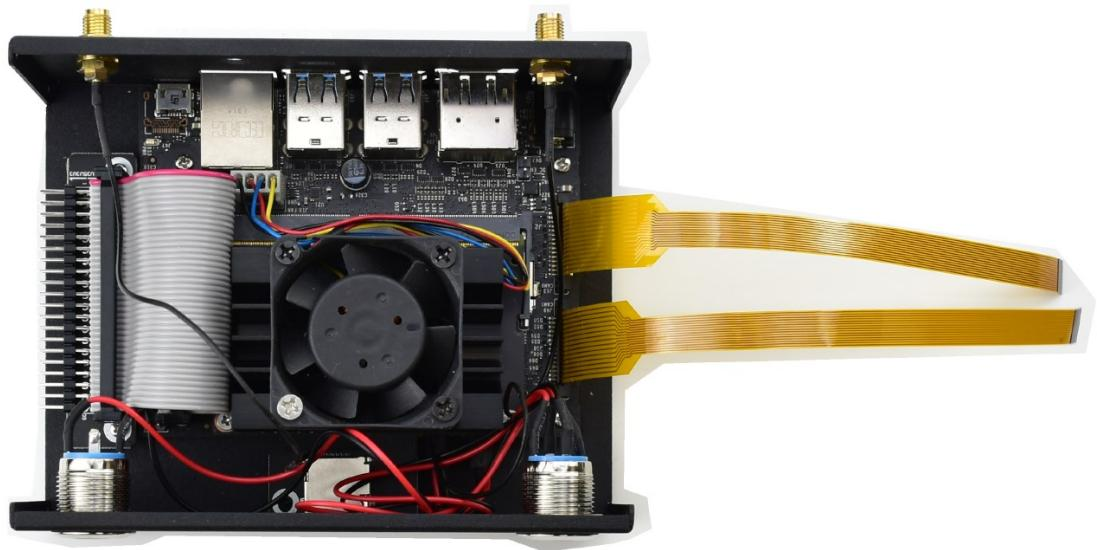
12. 将金属盒盖上，并用螺丝固定。将摄像头排线接入摄像头。将胶棒天线接上。
